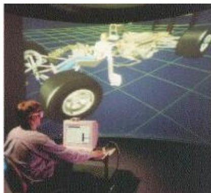
Figura 8: Sistema Virtual não imersivo com projeção em ecrã e com recurso a Shutter Glasses
