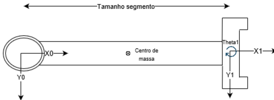
Figura 4.26: Escolha dos referenciais para o manipulador
