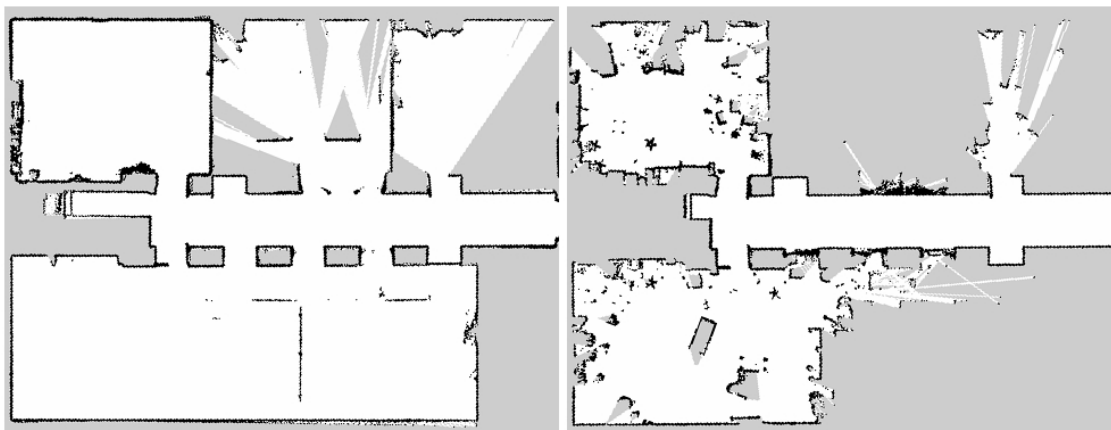
Figura 3.3: Comparação do resultado do mapeamento utilizando um laser de navegação a 1,9 metros de altura (esquerda) e um laser de segurança a 0,1 metros de altura (direita).
