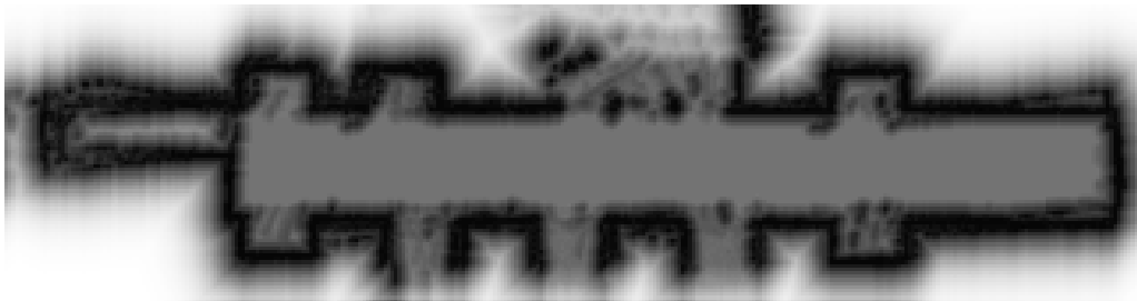
Figura 4.11: Fatia do mapa de distâncias tridimensional correspondente ao mapa de ocupação da Figura 4.10.
