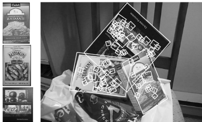
Figura 2.17: Esquerda: Objetos a ser reconhecidos; Direita: Resultado da aplicação do detetor SIFT [9]
