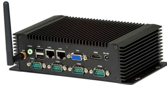
Figura 2.7: PC industrial com um processador Intel Atom N2800 3
