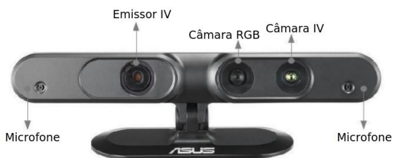
Figura 3.1: Identificação dos constituintes do sensor Asus
