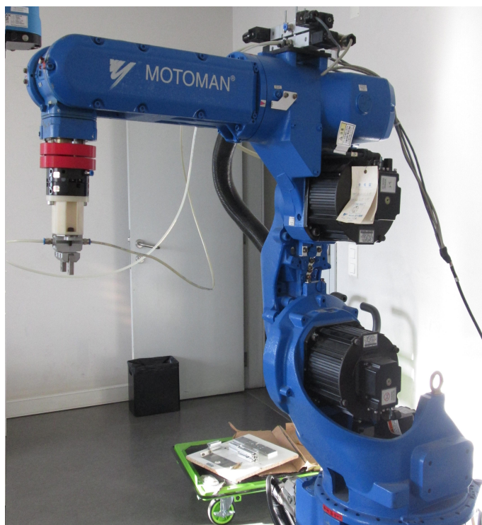
Figura 3.4: Sistema de atuação composto pelo manipulador Motoman e garra pneumática
