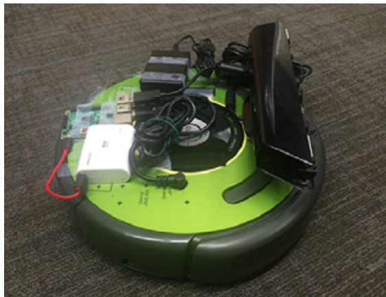
Figura 2.13: Sistema iRobot com respetiva unidade de aquisição e processamento [6]
