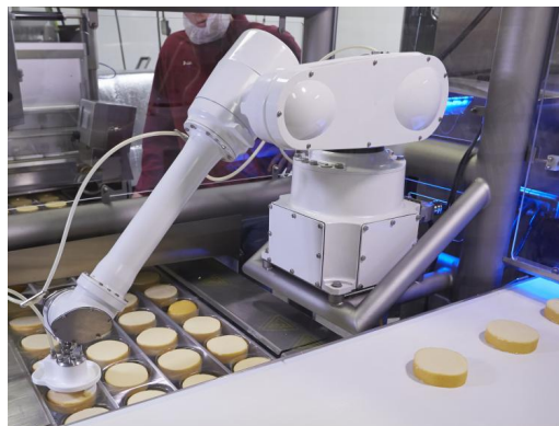
Figura 2.23: Operação de pick-and-place na indústria alimentar 9
