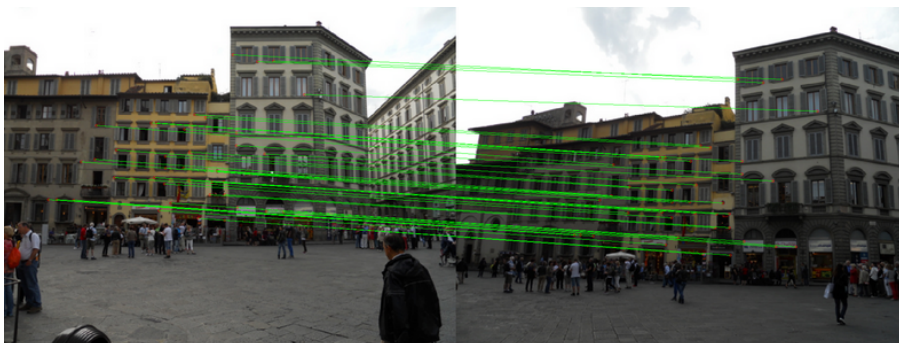
Figura 2.16: Esquerda: Imagem de treino; Direita: Resultados da aplicação do algoritmo RANSAC 7
