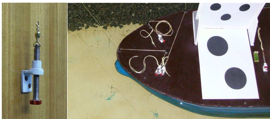
Figura 5 – Pormenor do mecanismo de ajuste das forças iniciais aplicadas nos cabos de amarração (esquerda); posicionamento dos quatro mecanismos instalados à proa do modelo do navio (direita).
