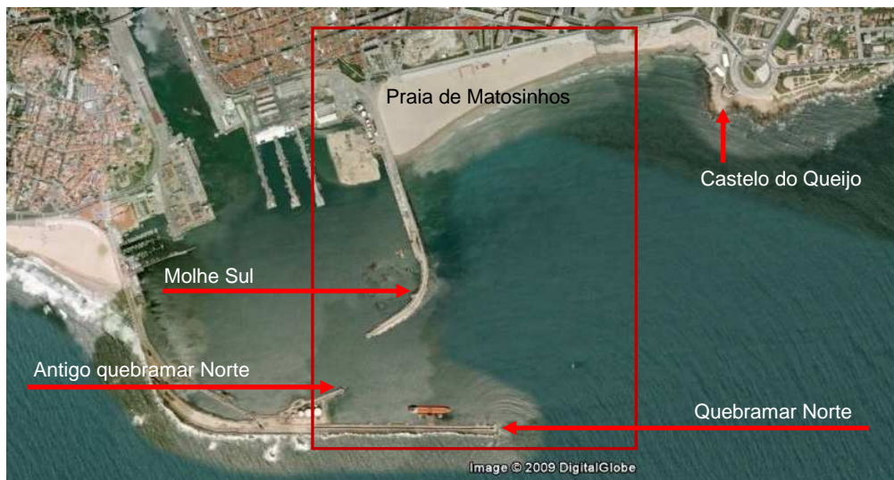
Figura 8 – Porto de Leixões e área envolvente, com delimitação da região reproduzida no modelo físico da segunda fase do estudo [fonte: Google Earth ].
