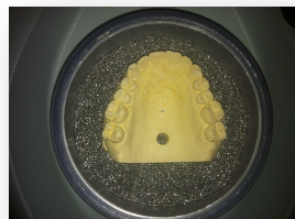
Fig. 2 - Colocação do modelo de gesso na máquina de vácuo.
