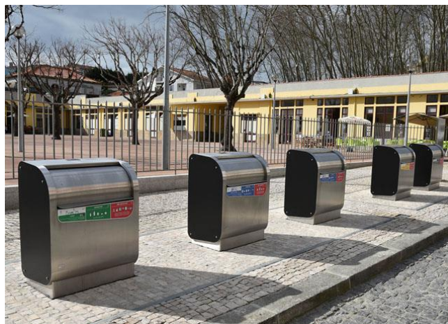
Figura 16 - Exemplo de um sistema PAYT através de contentores de proximidade de Vila do Conde com acesso controlado (Camara Municipal de Vila do Conde, 2016)
