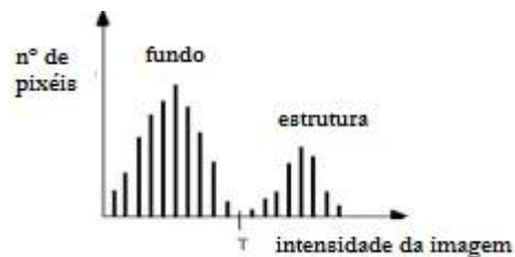
Figura 1 Exemplo de um histograma bimodal com um threshold seleccionado T .
