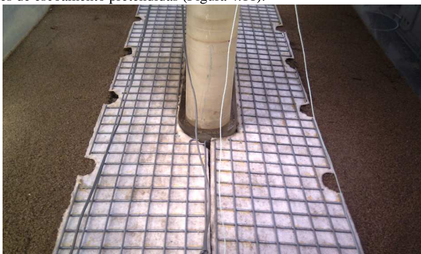
Figura 4.11 – Proteções têxteis aplicadas em volta dos elementos a ensaiar
