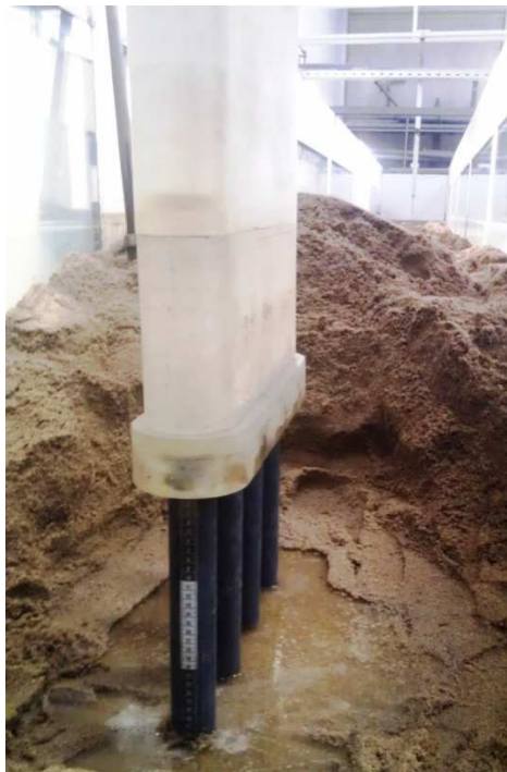
Figura 4.6 – Modelo do pilar complexo utilizado nos ensaios
