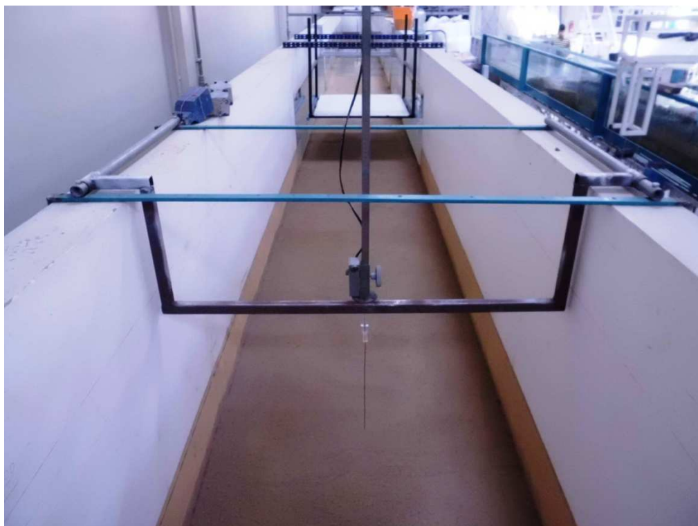
Figura 4.9 – Limnómetro para medição de profundidades de erosão aplicado na estrutura de suporte
