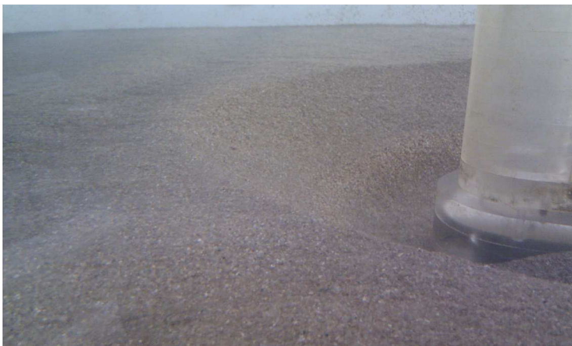
Figura 5.18 – Fotografia do ensaio F2, instantes antes de retirar a coluna
