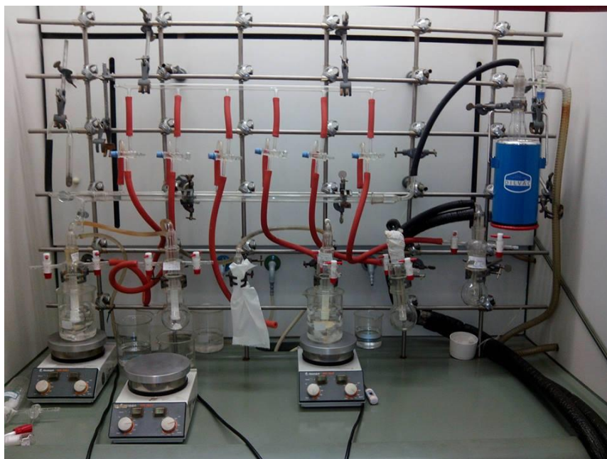
Figura 2.2 – Instalação para purificação de compostos por sublimação a pressão reduzida.
