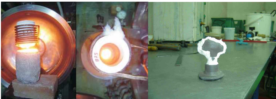
a) metal fundido a ser vertido na carapaça; b) metal fundido no interior do cadinho cerâmico; c) remoção da carapaça cerâmica.
