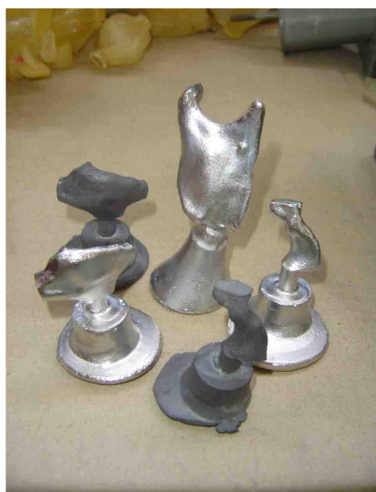
Figura 6 - Implantes em diferentes tipos de ligas metálicas não reactivas obtidos por conversão indirecta de modelos de PR.
