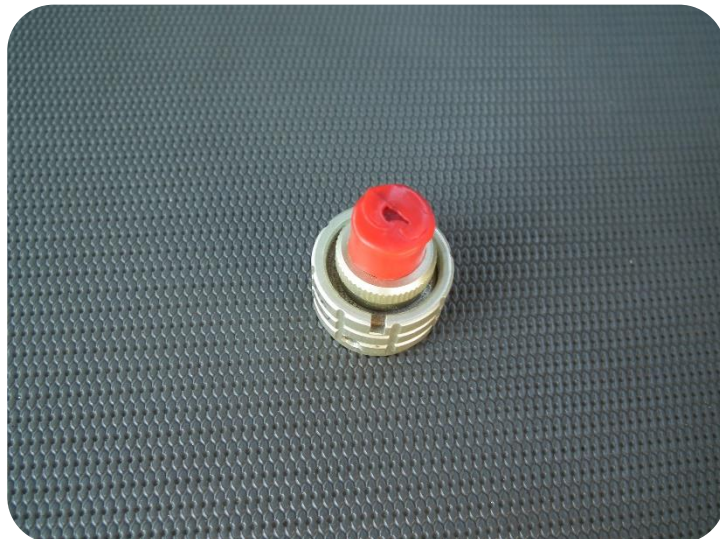
Figura 45: Módulo wireless que possibilita a ligação entre transmissor e PocketPC sem fios.
