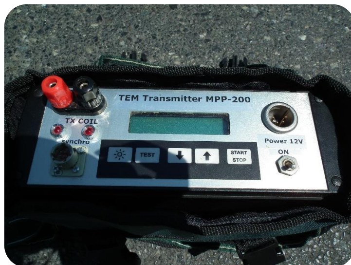
Figura 42: Transmissor TEM-200 do sistema AIE-2.
