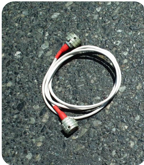
Figura 44: Sincronizador que permite coordenar os períodos de time-on e time-off entre o transmissor e recetor.
