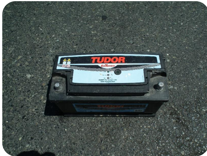
Figura 46: Bateria de 12V, fonte externa de energia do sistema.
