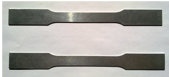
Figura 4.1 - Provete caracterização da chapa das faces EN AW 5754 (AlMg3).
