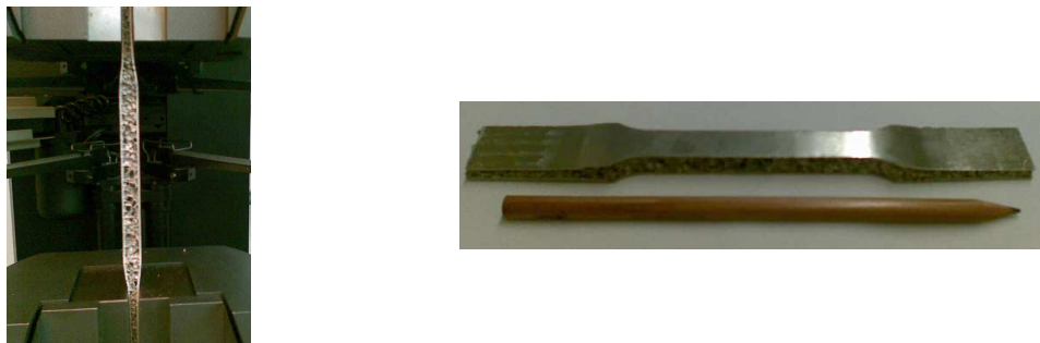
Figura 4.18 - Ensaio tração problemas de amarração.
