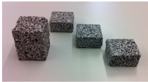
Figura 4.15 - Variação de espessura sofrida pelos provetes ensaiados.
