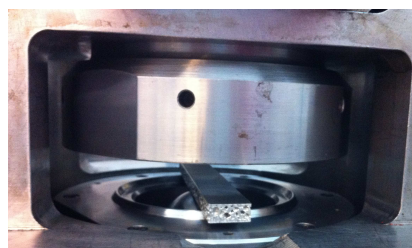
Figura 6.30 - Configuração das Ferramentas e esboço no ensaio experimental de punção esférica.
