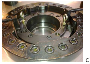
Figura 6.51 - Ensaio hidráulico de Expansão Biaxial, a) Provetes, b) Ação do cerra-chapas, c) Bulge test.
