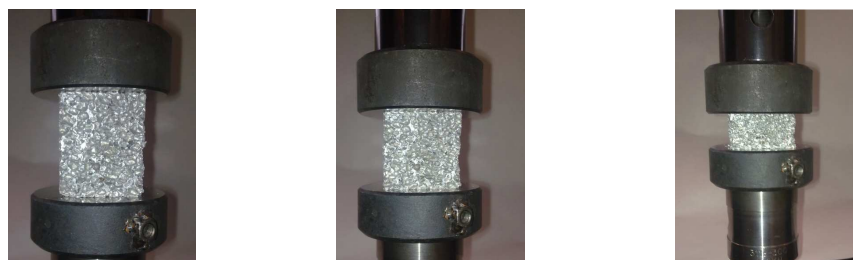
Figura 4.14 - Ensaio compressão - Caracterização da espuma.
