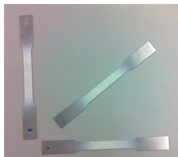
Figura 4.5 - Provetes com diferentes valores e \alpha relativamente à direção de laminagem usados.
