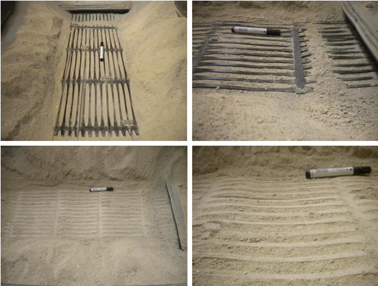
Figura 6.54 - Fotografias tiradas após o ensaio de arranque cíclico realizado com I_D = 85\% , \sigma_n = 25 kPa, F_i/P_R = 0,50 , f = 0,1 Hz, A_f/P_R = 0,40 e n = 120
