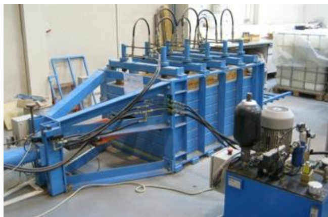
Figura 3.31 - Vista geral do equipamento de ensaio de arranque do LGS da FEUP
