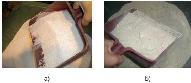
Figura 3.1 - Aspetto visual dos solos utilizados: a) areia limpa; b) solo residual do granito
