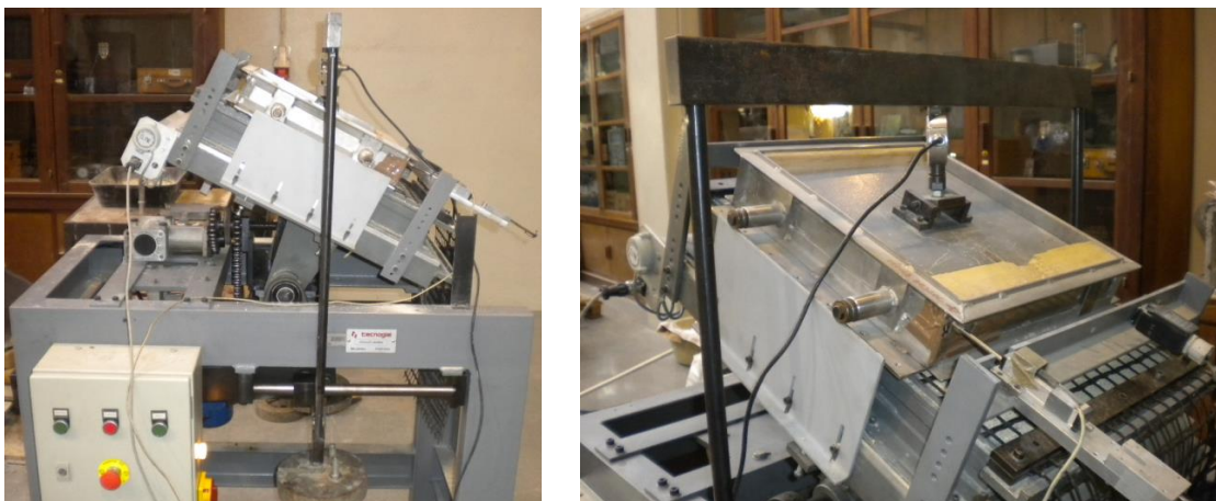
Figura 3.24 - Equipamento de ensaio de corte em plano inclinado do LGS da FEUP
