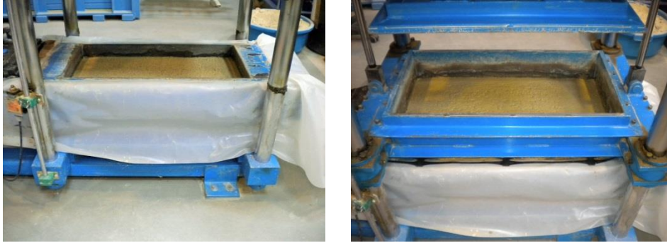
Figura 3.23 - Plástico protetor utilizado nos ensaios realizados com w = 1,5 w_{\text{ót}}
