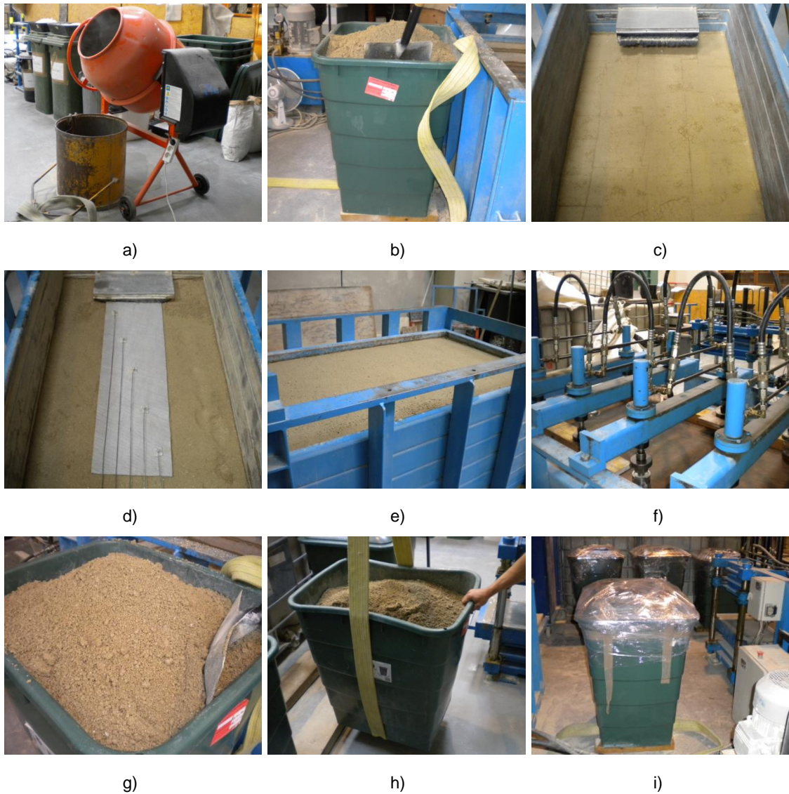
Figura 3.39 - Preparação de um ensaio de arranque com solo húmido: a) betoneira; b) solo correspondente a uma camada; c) primeira camada de solo colocada; d) geossintético; e) caixa preenchida com solo; f) aplicação da carga vertical; g) solo retirado da caixa; h) transporte do recipiente; i) armazenamento do solo
