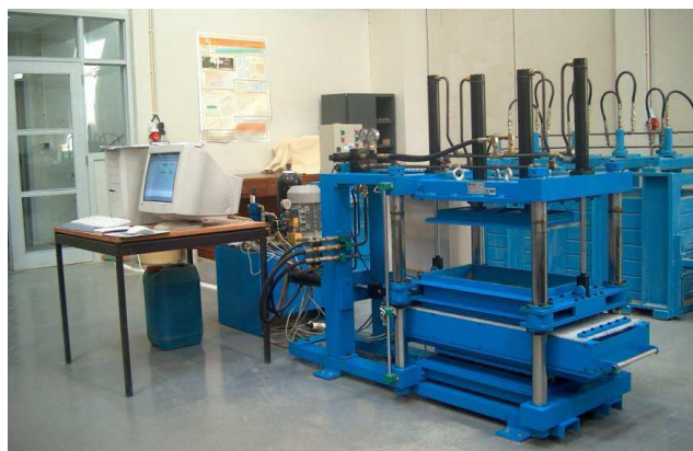
Figura 3.15 - Vista geral do equipamento de ensaio de corte direto do LGS da FEUP
