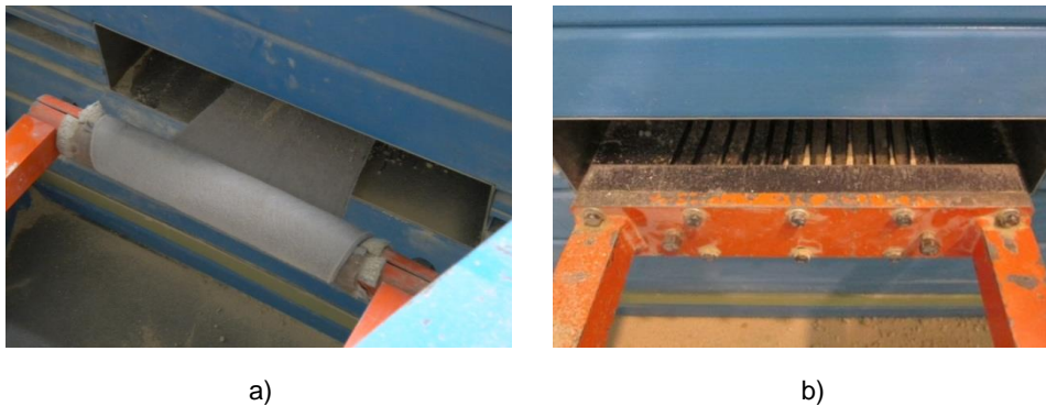
Figura 3.35 - Pegas do equipamento de ensaio de arranque: a) pega cilíndrica; b) pega de cunha
