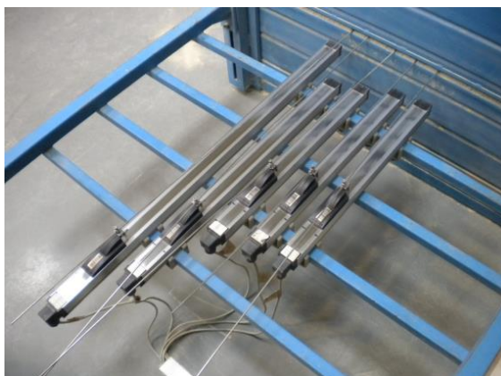
Figura 3.34 - Potenciômetros lineares do equipamento de arranque
