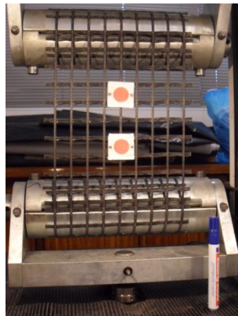
Figura 3.7 - Provede de GGRB antes do ensaio de tração
