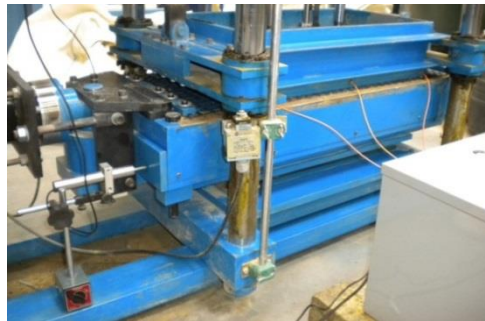
Figura 3.21 - LVDT para monitorização do deslocamento horizontal da meia-caixa inferior nos ensaios de corte direto cíclico
