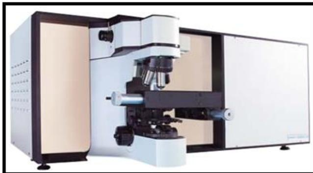
Figura 28: Micro espectralógrafo Raman utilizado: Raman LabRAM HR800 (Horiba-Jobin), do Instituto de Investigação e Inovação na Saúde (i3S).
