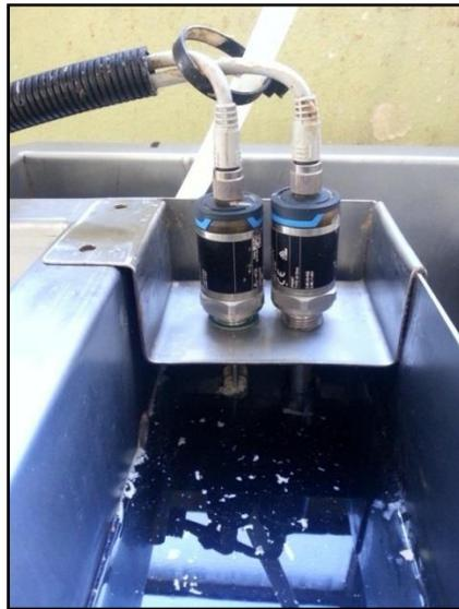
Figura 21: Sensores *Liquiphant FTL31*
