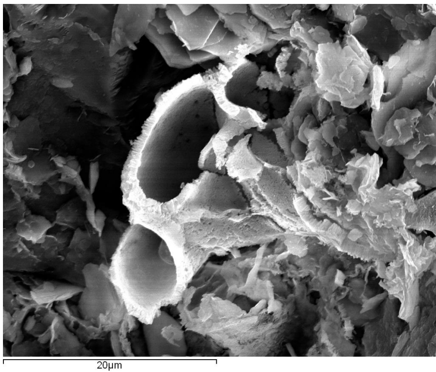
Figura 3.26 - Fragmento de concha rodeado de partículas de argila
