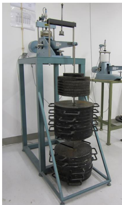
Figura 7.29 – Aspeto do edómetro de alta pressão com a máxima carga aplicada (450 kg e placa de topo)
