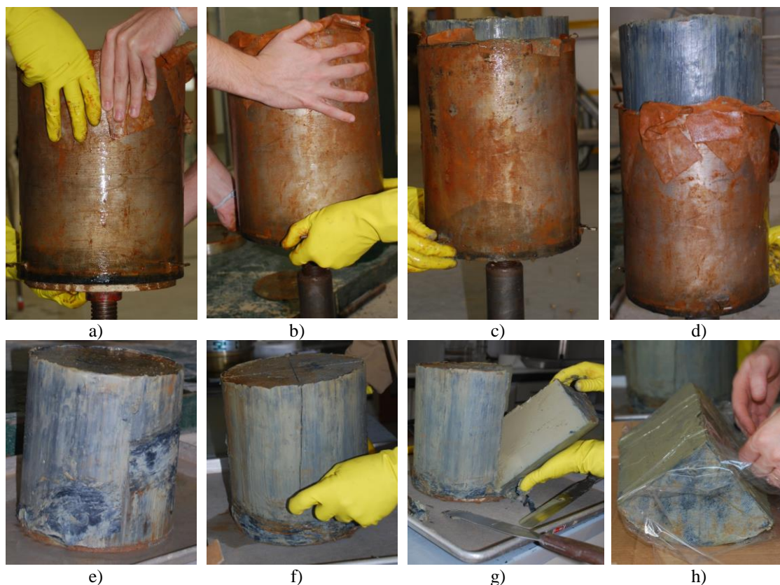
Figura 7.8 – Extração do solo remoldado no consolidómetro: a) colocação do molde num suporte sobre um macaco hidráulico; b) fixação do molde; c) e d) subida do solo; e) aspeto do solo remoldado; f) corte em quatro partes para armazenamento; g) separação de uma das partes; h) proteção com película aderente prévia à aplicação da parafina
