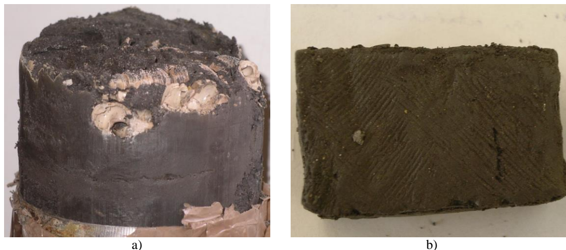
Figura 3.12 - a) Aspeto da amostra 7 (85,5 mm de diâmetro) com fragmentos de fósseis de dimensão centimétrica. b) Prisma de amostra (taco) a partir do qual foram preparadas as lâminas polidas para observação no MOP (50 mm de comprimento)
