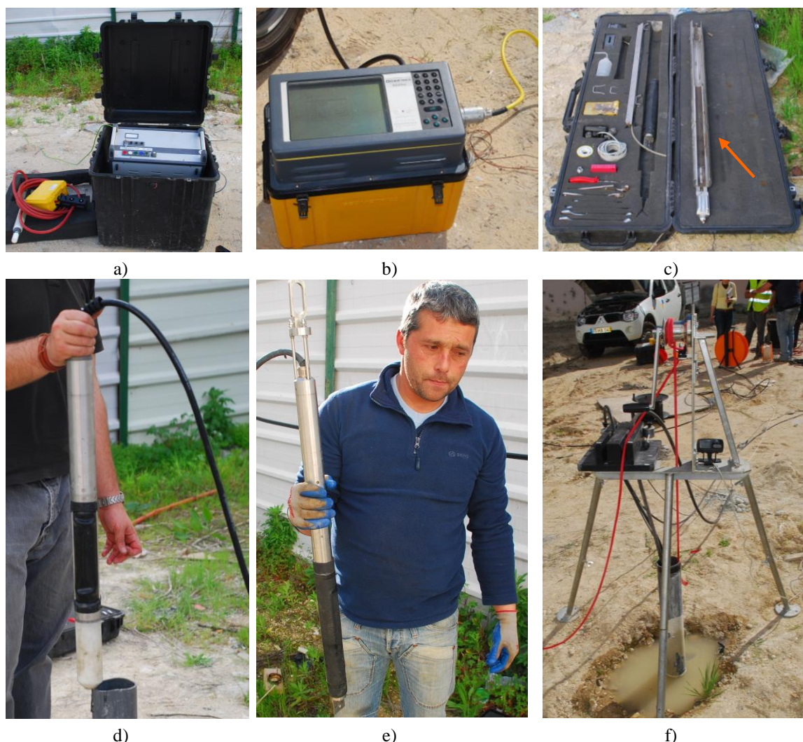
Figura 8.14 – Alguns aspetos da execução dos ensaios sísmicos entre furos no campo experimental: a) gerador de impulsos e unidade de controlo; b) sismógrafo; c) calha com bússola para sparker nas ondas S; d) sistema de aquisição triaxial; e) sparker de ondas S; f) aspeto geral do sparker instalado no furo
