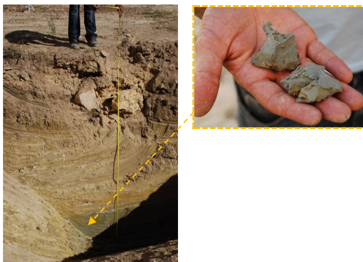
Figura 7.2 – Aspeto da vala correspondente ao início da escavação do poço com identificação unidade Camadas de Prazeres
