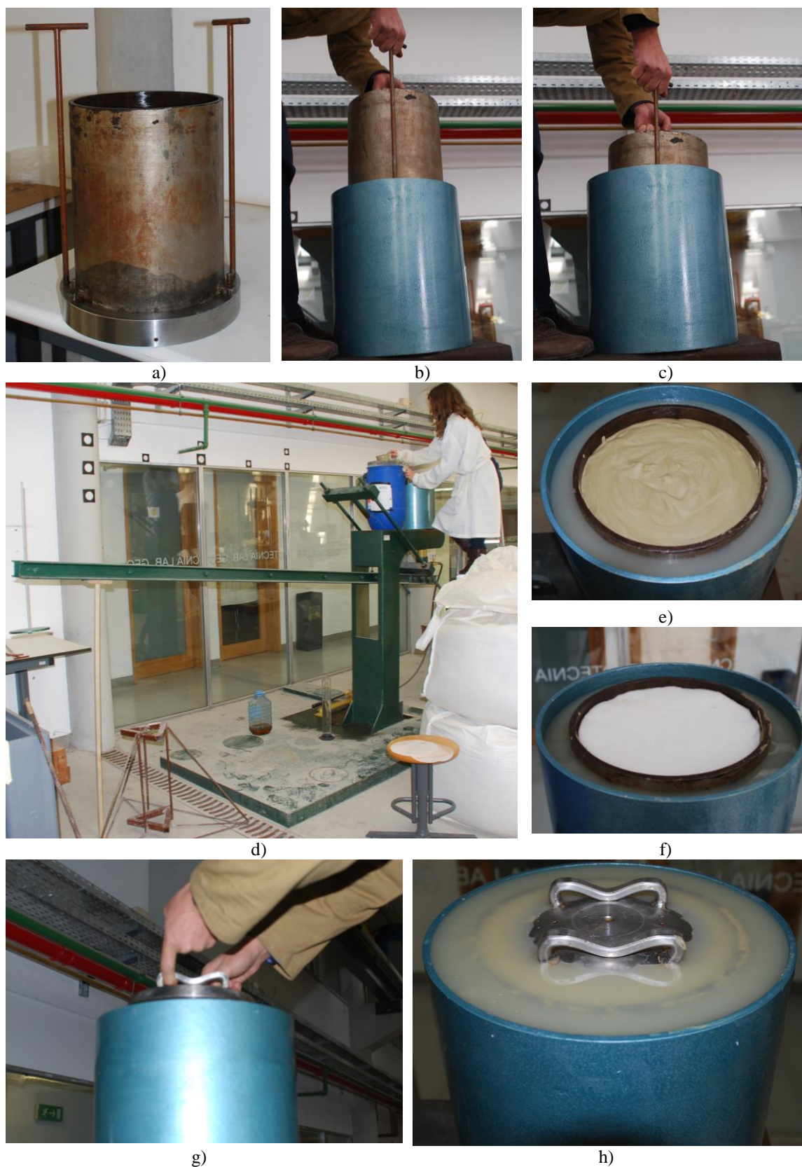
Figura 7.7 - Montagem da lama no consolidómetro da FCTUC: a) célula montada na base; b) e c) colocação da célula no consolidómetro; d) colocação da lama no interior da célula; e) enchimento do consolidómetro com água; f) papel de filtro e geotêxtil colocados no topo da amostra; g) colocação da placa de topo; h) aspeto final do consolidómetro
