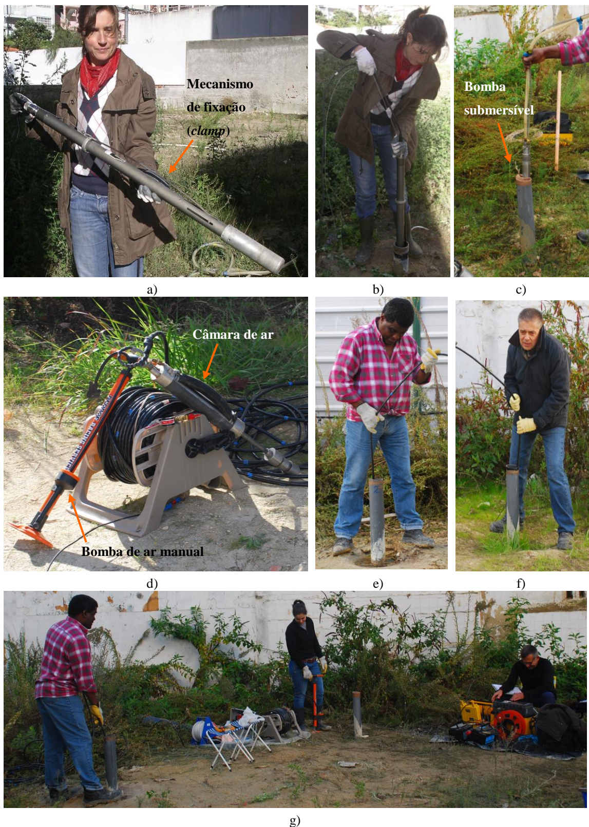
Figura 8.15 - Execução dos ensaios sísmicos entre furos usando como fonte o martelo gravítico no campo experimental: a) sistema de aquisição triaxial; b) introdução do geofone no furo; c) retirada da água do interior do furo; d) martelo gravítico; e) descida do martelo no tubo; f) disparo do martelo gravítico; g) vista geral do ensaio
