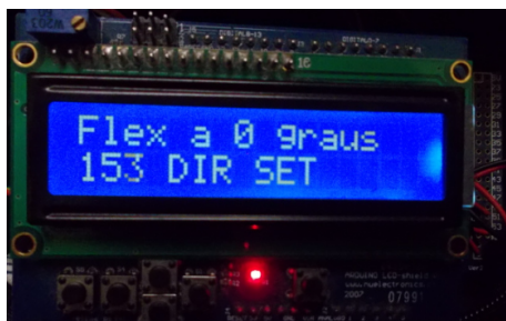
Figura 5.20 – Calibração dos sensores embutidos nas bandas elásticas.
