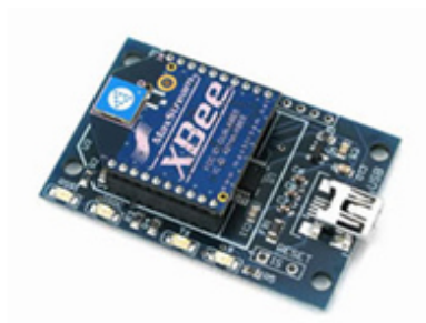
Figura 4.12 – a) Placa USB-XBee com módulo XBee (retirado de [XBee, 2013]).
