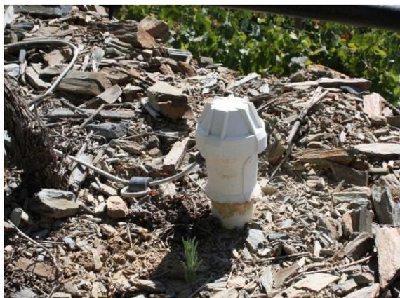
Figura 10 Sonda EnviroSCAN® 150, que monitoriza a humidade do solo.
