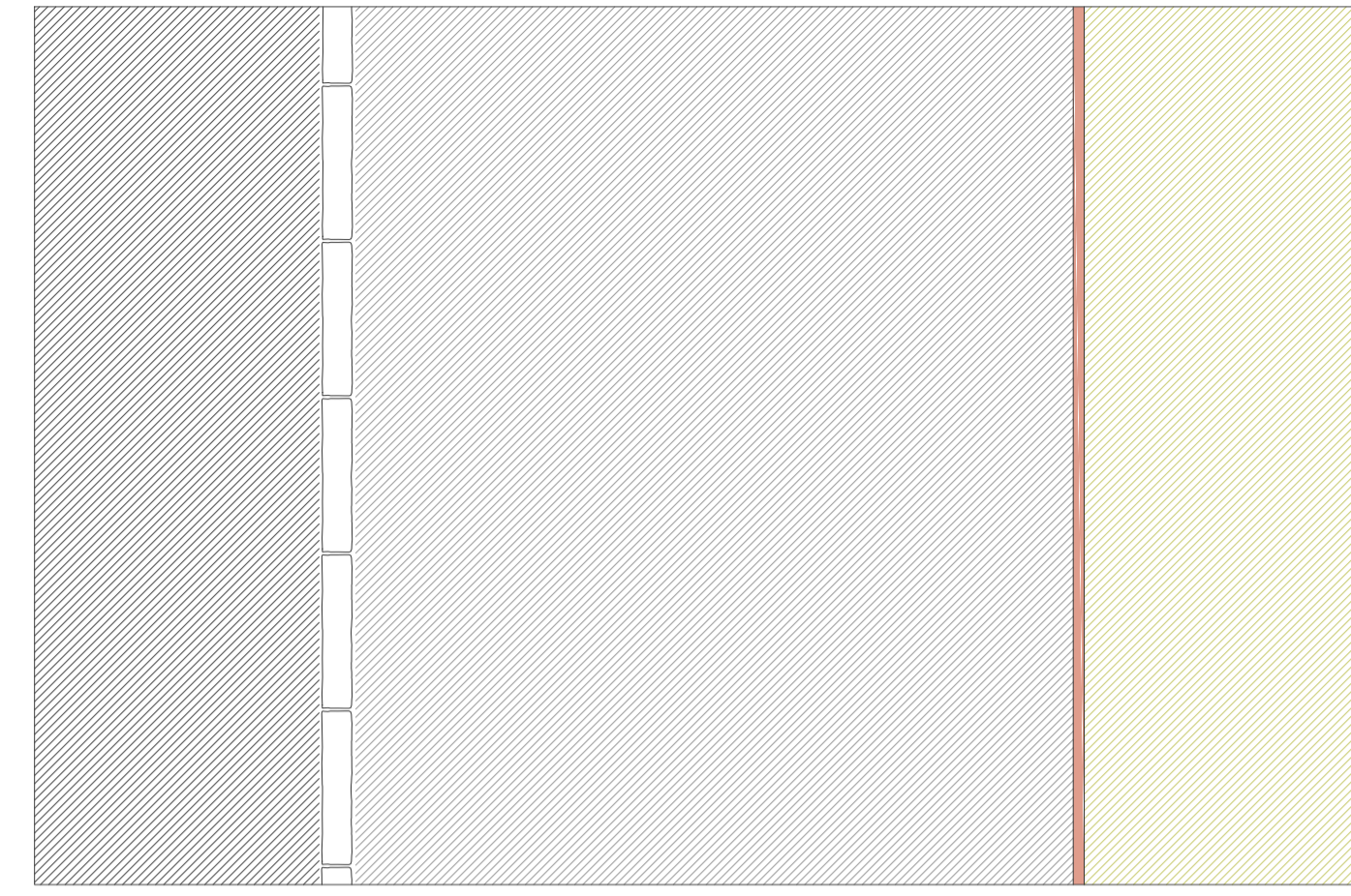
P3 | pavimento em betuminoso para circulação automóvel - lancil em granito - pavimento em betuminoso para circulação pedonal - lancil em aço corten - espaço verde planta | 1:20
