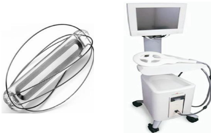
Figura 2.3 - Sensor EndoSure de primeira geração [36] (à esquerda) e monitor externo e antena para leitura [34] (à direita).
