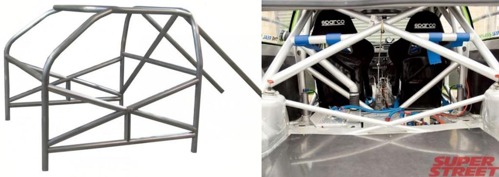
Figura 2 - À esquerda roll cage [6], á direita a instalação e a sua envolvência num carro de competição [7]
