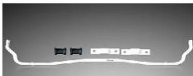
Figura 3 - Barra estabilizadora Traseira [9]
