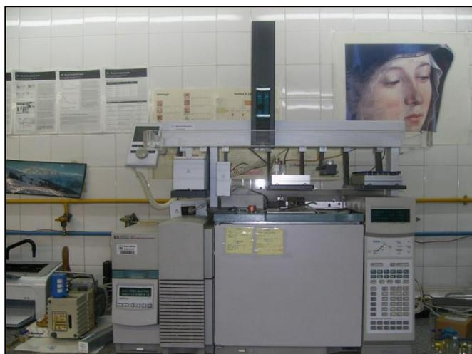
*Figura 3.6- Equipamento GC-MS*
