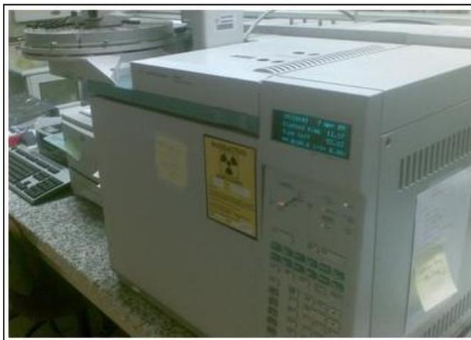
**Figura 3.7-** Cromatografia de gases com detetor de ionização de chamas
