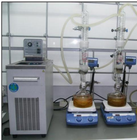
*Figura 3.17- Extração com Soxhlet*
