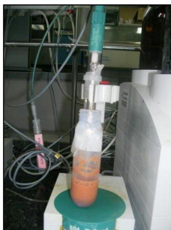
**Figura 3.15- Eletrodo Medidor de pH**
