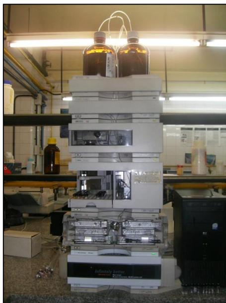
Figura 3.13- Equipamento HPLC
