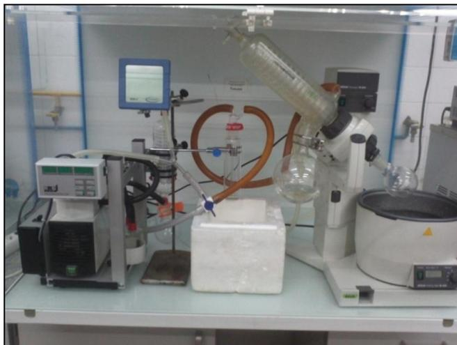
**Figura 3.18-** Evaporador Rotativo
