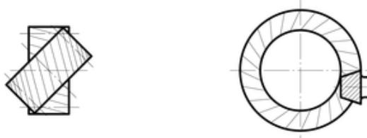
Figura 7.3 Roda dentada eixos cruzados (retirado de <https://www.iso.org/obp/ui/#!iso:std:5649:en> )
