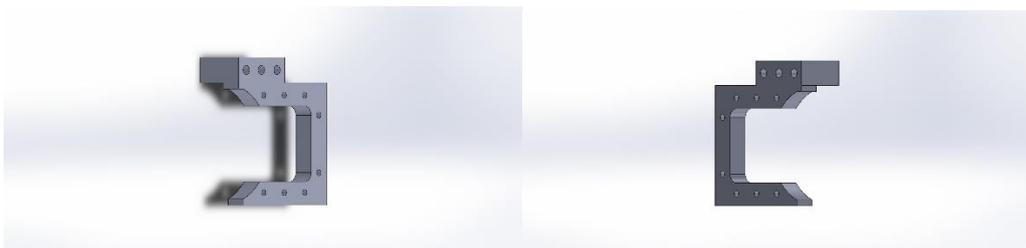
*Figura 4.46 Ligação aos motores simétricos*
