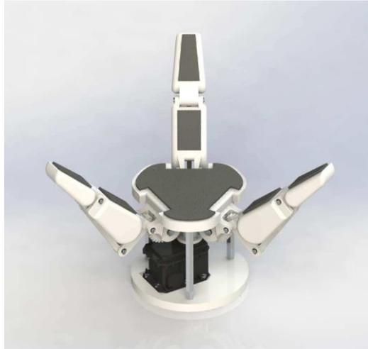
Figura 4.1 Modelo-base da garra concêntrica de 3 dedos (Telegenov et al., 2015)
