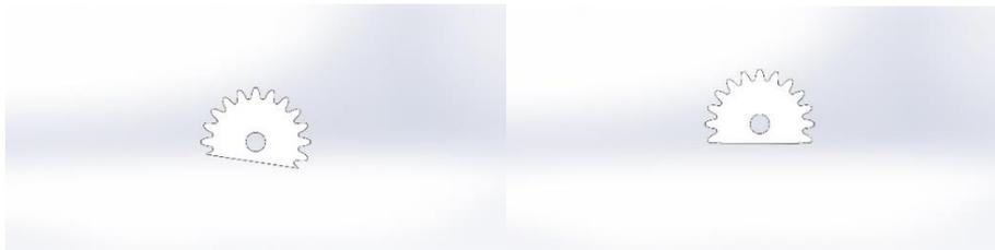
*Figura 4.14 Segmentos de rodas dentadas das extremidades.*
