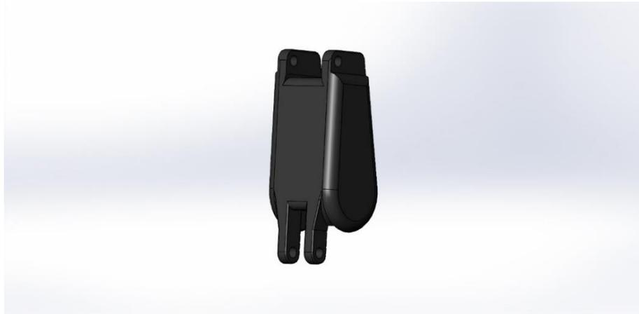
*Figura 4.31 Falange proximal do modelo base (Telegenov et al., 2015)*
