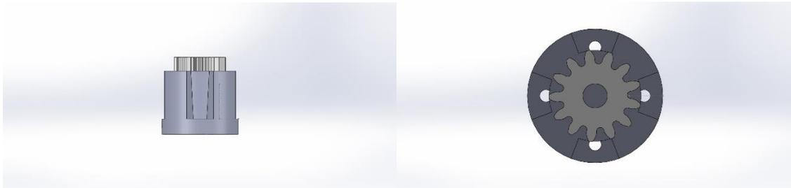
*Figura 4.40 Roda dentada motora com o suporte de ligação ao motor*
