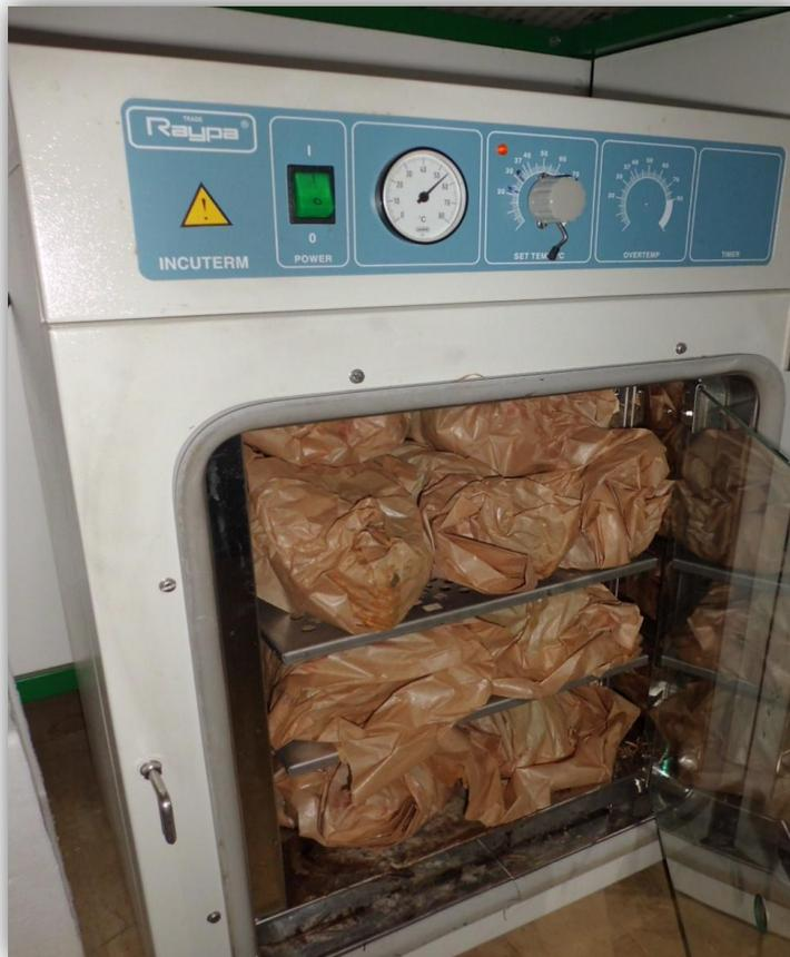
Figura 55 - Estufa do laboratório para dessecar as amostras de FVH. Fonte: Autor
