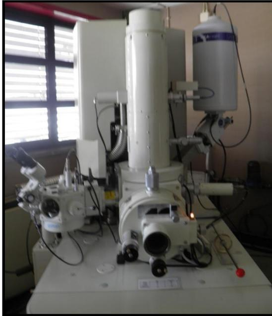
**Figura 14** - Aparelho de microscopia eletrônica de varrimento da marca JEOLJSM6301F utilizado para caracterização morfológica e microestrutural das superfícies dos implantes com elevada resolução espacial
