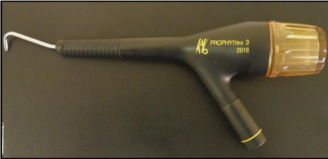
**Figura 9** - Fotografia do jato de ar abrasivo utilizado neste trabalho
