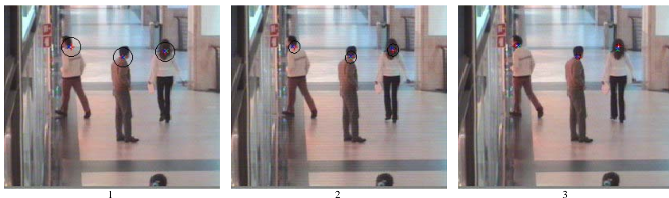
Figura 13. Seguimento de 5 marcas em 5 quadros não-consecutivos retirados de uma sequência de imagens verificando-se a robustez da abordagem proposta mesmo quando a área das elipses de covariância de posição não contém as medições.
