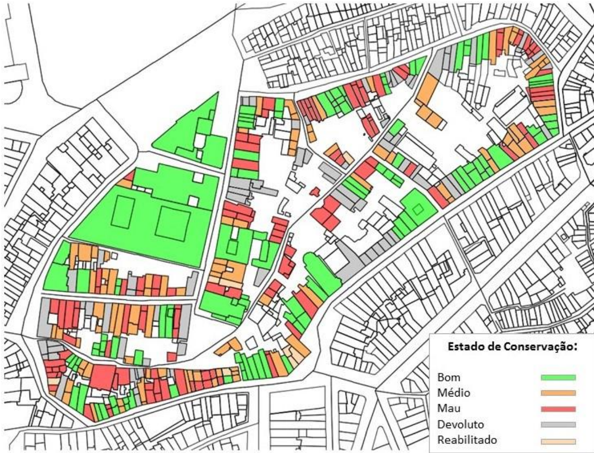
Fig. 3.7 - Estado de Conservação dos edifícios de Vitória
