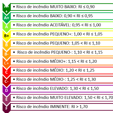
Fig. 3.19 - Escala de Classificação de Riscos de Incêndio [4]
