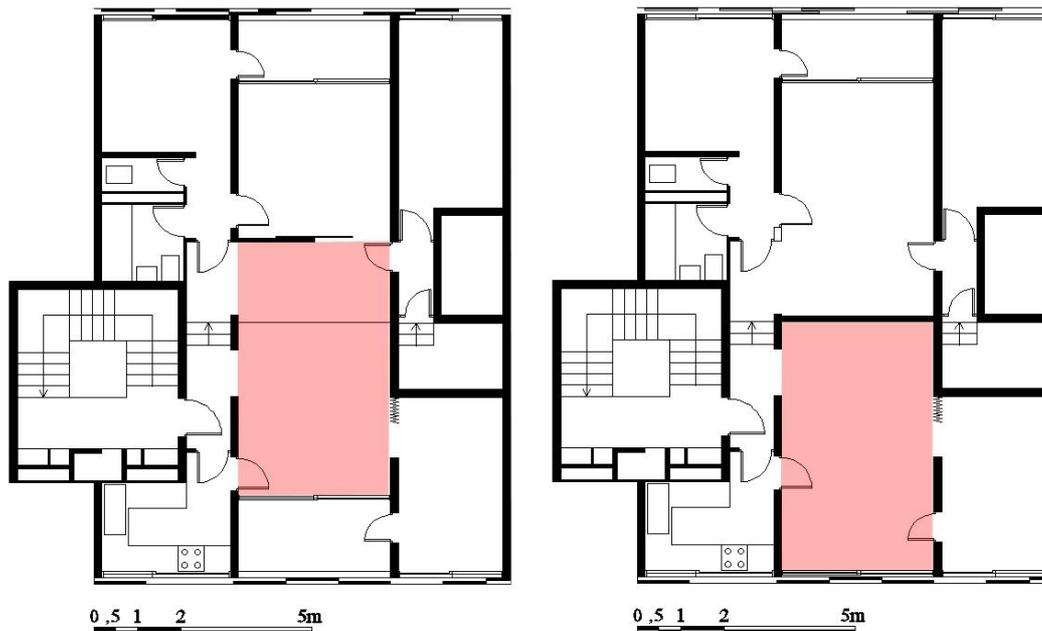
12. À esquerda: o estado original do apartamento. À direita: alterações efectuadas pelos habitantes que consistem em encerrar o espaço flexível e retirar as caixilharias existentes aumentando a superfície da sala.
