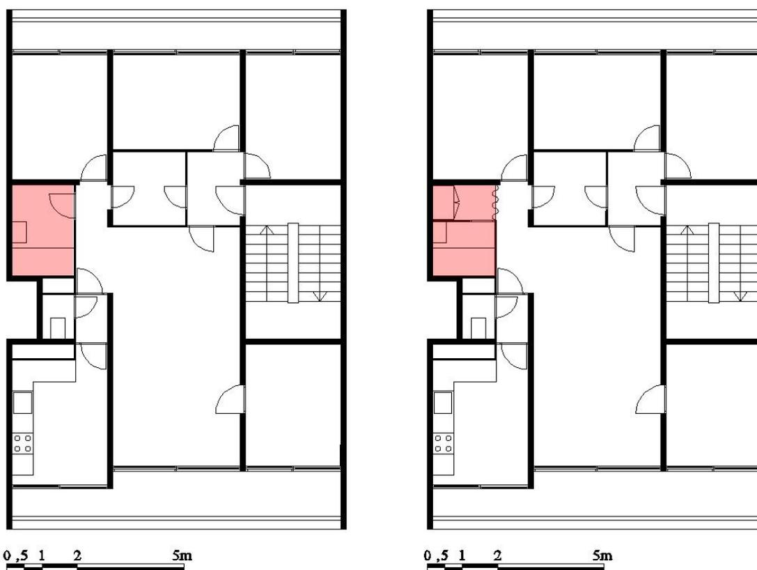
13. À esquerda: o estado original do apartamento. À direita: alterações efectuadas na casa de banho de um dos apartamentos do edifício Le Tintoret. A entrada passou a ser efectuada pela lateral, e o acesso é fechado através de uma cortina.
