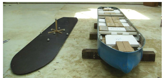
Figura 16. Modelo do navio com pesos de lastro no interior.
