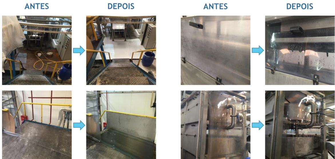
Figura 20 - Restauração da máquina - chão da linha e da plataforma (dir.) acrílicos e cortinas (esq.)
