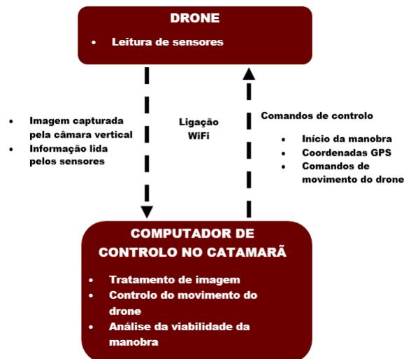
Figura 4.1: Esquema de comunicação entre o computador de controlo e o drone
