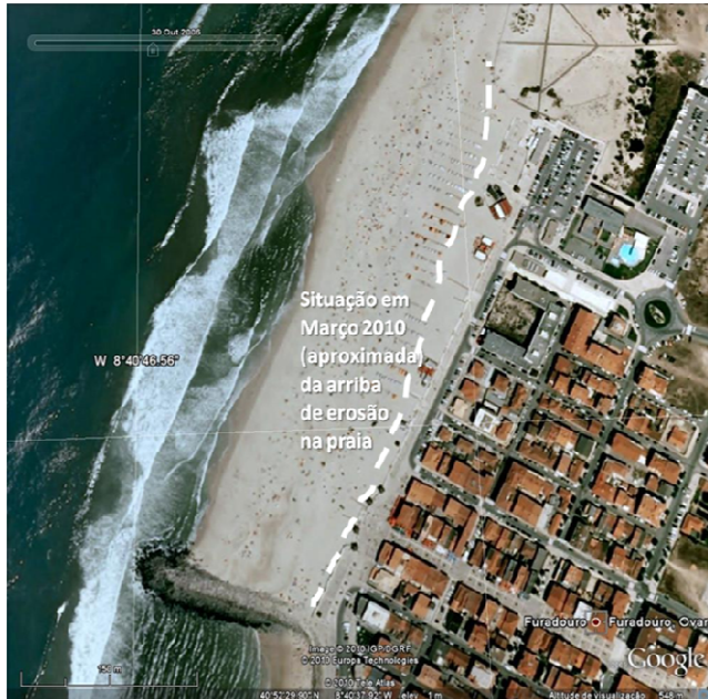
Figura 1. Praia a Norte do esporão Norte do Furadouro em 2006 e em Março de 2010 (indicação aproximada da arriba de erosão). O elevado défice sedimentar e a ocorrência de temporais de Sudoeste não favorece a acumulação de sedimentos nem mesmo a Norte (barlamar) dos esporões.
