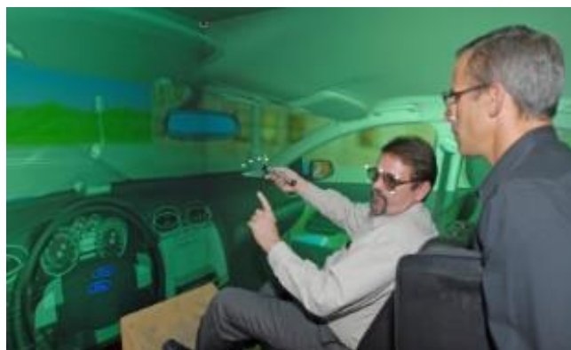
FIG.2.20 - SISTEMA DE TESTE SEMELHANTE AO CAVE UTILIZADO PELA FORD NO DESIGN DOS SEUS AUTOMÓVEIS, ADAPTADO DE AUTOTRENDS MAGAZINE [38]
