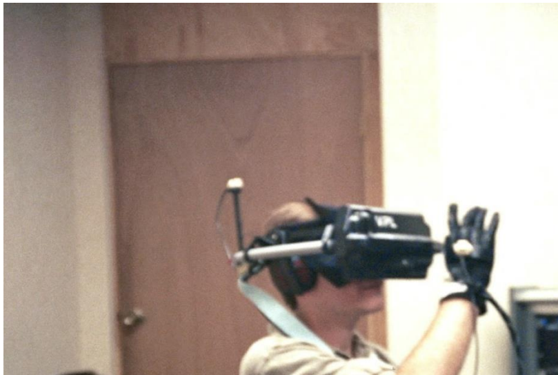
FIG.2.12 - EYEPHONE DESENVOLVIDO PELA EMPRESA DE RV VPL NA DÉCADA DE 60 [16]
