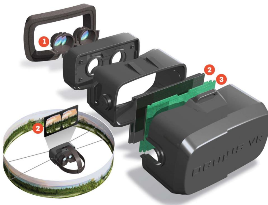
FIG.2.16 - ESQUEMA DA CONSTITUIÇÃO DO OCULUS RIFT DK2 [13]
