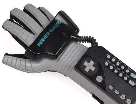
FIG.2.14 EQUIPAMENTO DE RV NINTENDO POWER GLOVE, ALTERNATIVA À INTERAÇÃO FEITA COM JOYSTICK OU TECLADO [23]
