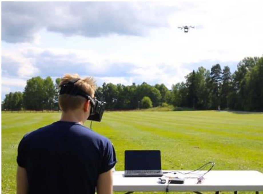
FIG.2.8 – COMBINAÇÃO DE CONTROLO DE UM DRONE E VISUALIZAÇÃO DO PERCURSO ATRAVÉS DE UM HMD [12]
