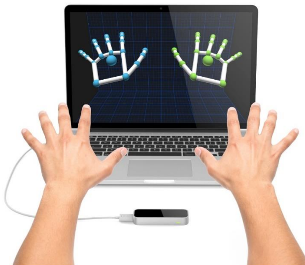
FIG.2.15 - SISTEMA DE DETEÇÃO DE MOVIMENTOS GESTUAIS THE LEAP, ATUALMENTE DESIGNADO COMO LEAP MOTION [18]
