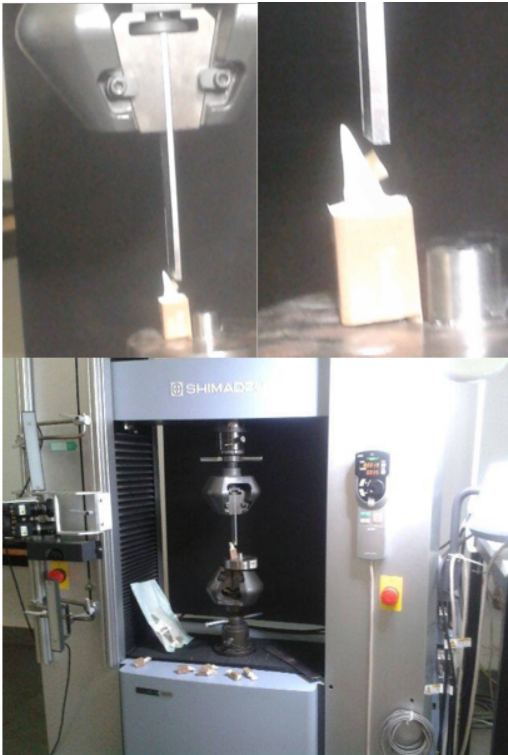
Figura 7 - Testes de resistência às forças de cisalhamento na máquina de ensaios universal
