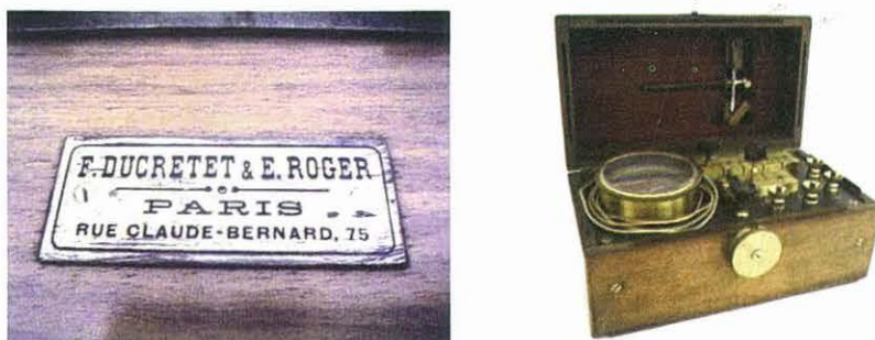
Figura 3. Aparelho portátil para medidas rápidas de F. Ducretet & E. Roger, Paris, fornecedor do Instituto Industrial do Porto
