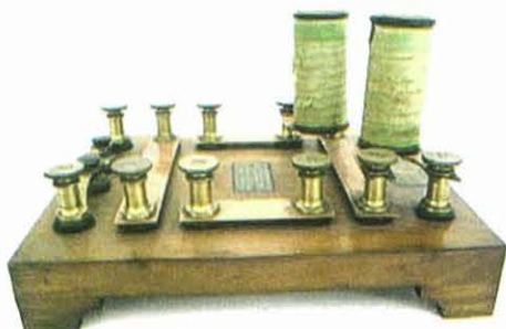
Figura 2. Aparelho para medir resistências de G. Fontaine, Paris, fornecedor do Instituto Industrial do Porto
