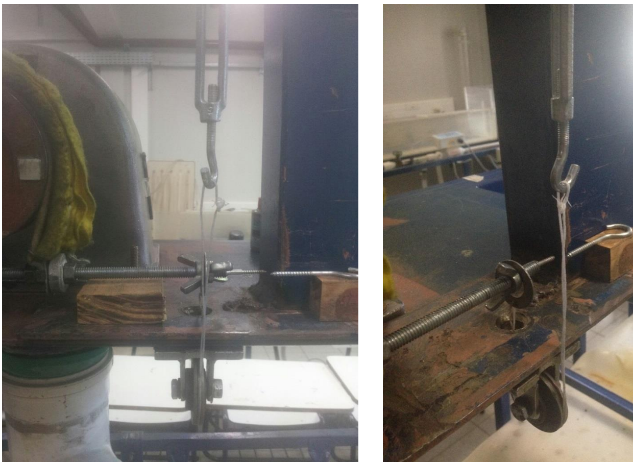
Figura 16 - Fotografia do mecanismo que possibilita a medição do binário resistente
