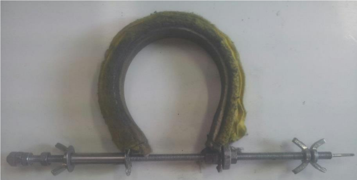
Figura 18 - Freio Prony com feltro industrial que obteve sucesso nos ensaios
