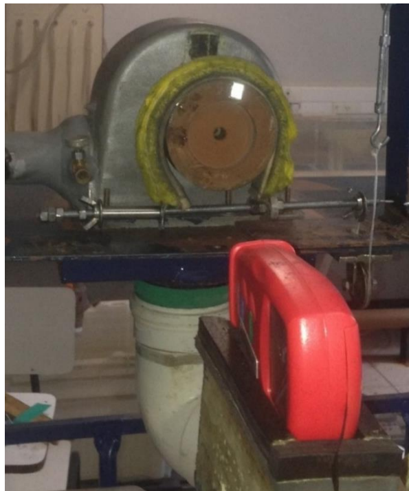
Figura 15 - Tacómetro e alvo refletivo no volante da turbina
