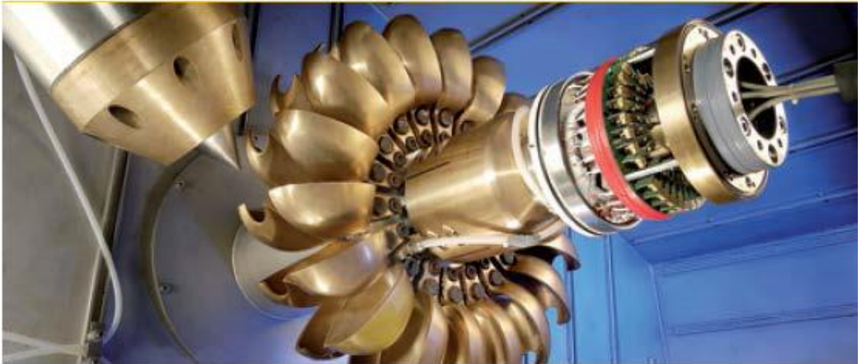
Figura 2 - Fotografia pormenorizada do jato e das conchas de uma turbina Pelton
