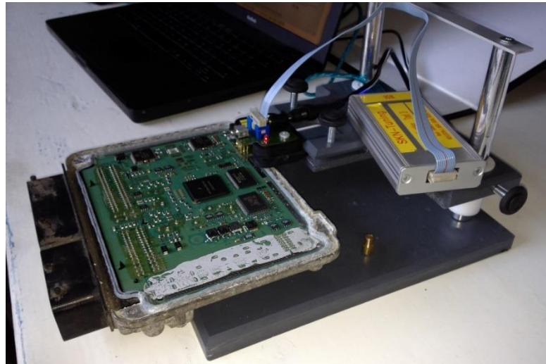
Figura 58 - Método de programação por BDM
