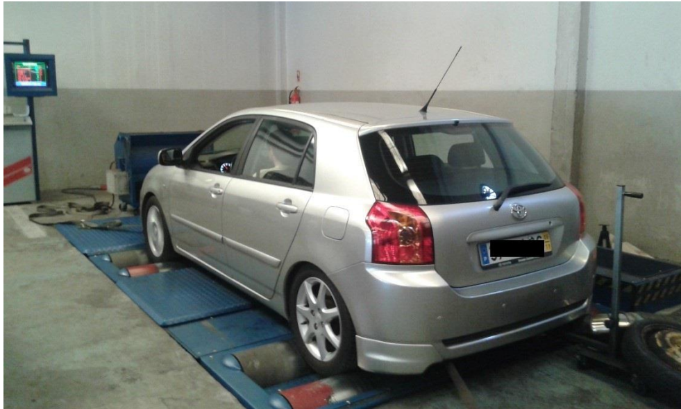
Figura 78 - Teste em banco de potência na Autoperformance
