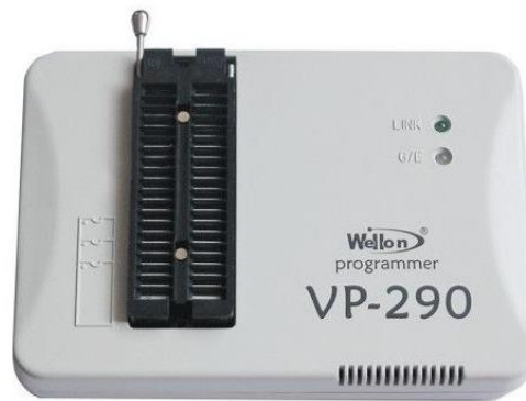
Figura 56 - Programador de Eeprom (Obdspace 2012)
