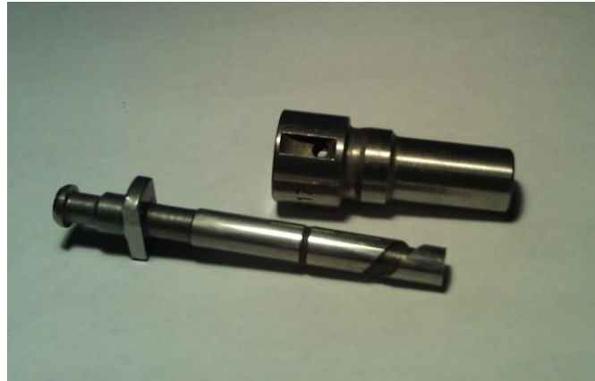
Figura 38 - Conjunto pistão (frente) e cilindro (atrás) (Breckenridge 2012)
