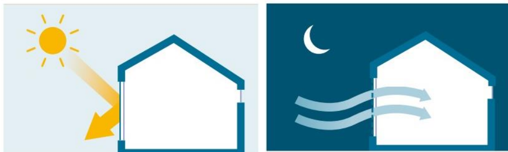
Fig. 2.10. - Efeito conjunto da inércia térmica com ventilação natural para arrefecimento [20]
