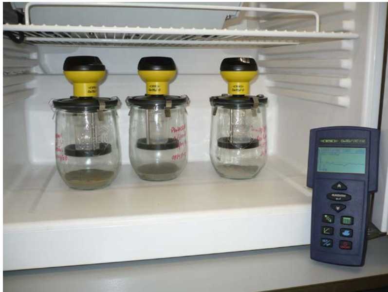
Ensaio em Respirómetros Oxi-Top
