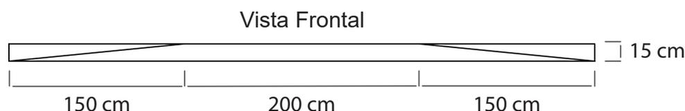
*Figura 34. Vista frontal da primeira sugestão de rampa com dupla finalidade. Dimensões: 15 cm (altura); 500 cm (largura) divididos em três partes, ou seja, 150 cm (rampas laterais) e 200 cm (rampa frontal).*
