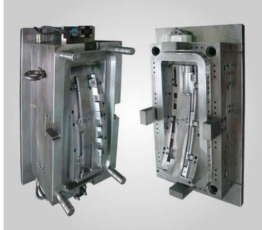
Figura 4 - Molde de injeção de plástico (Nimax utilizado na bucha e cavidade) [5].
