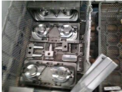
Figura 1 - Moldes em aço antes do tratamento de nitruração.
