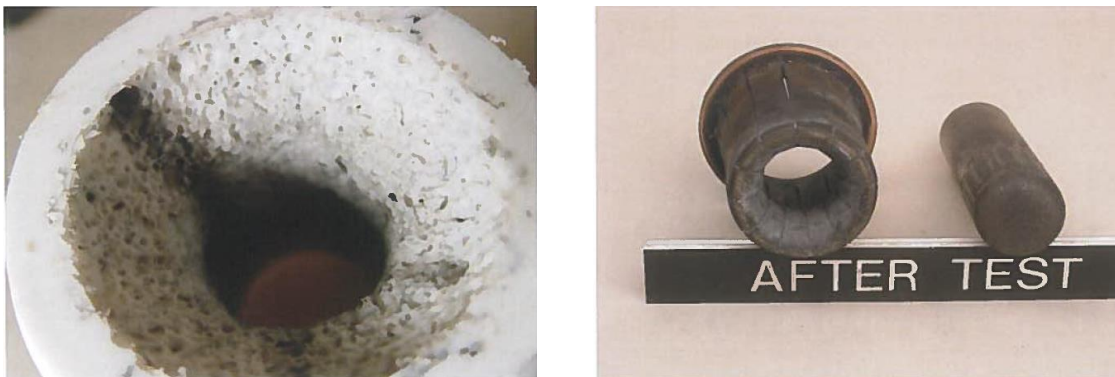
Figura 4.9: Degradação da tubeira (esquerda) e dos contatos (direita)
