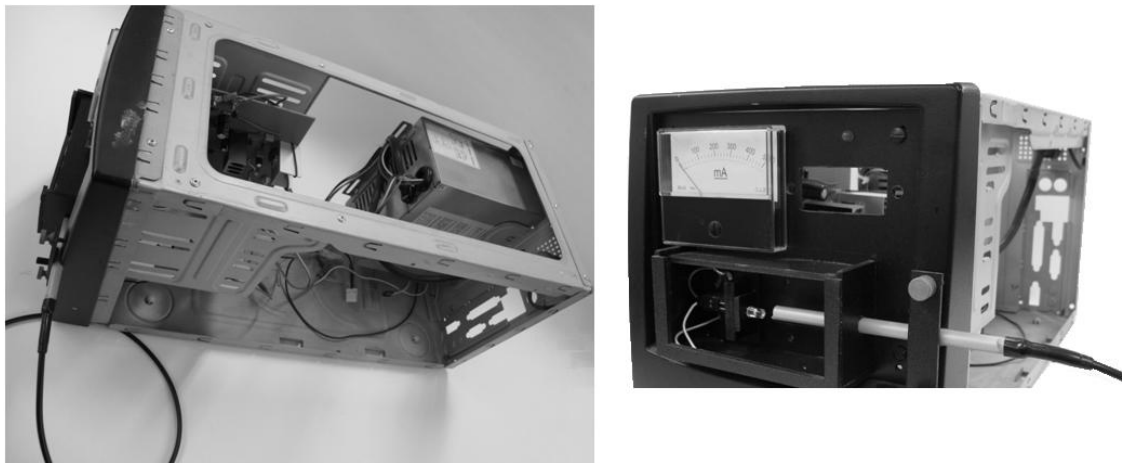
Figura 2.8 – Fotografia da montagem da fonte de alimentação elétrica estabilizada para alimentar LEDs, esquerda. Vista de frente com pormenor do suporte para os LEDs, direita.
