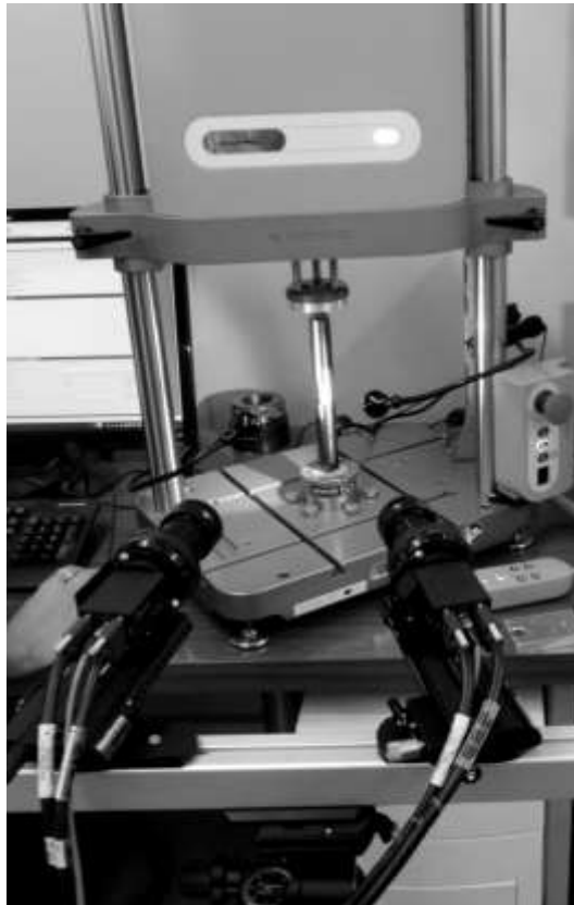
Figura 7.24 - Configuração do sistema DIC-3D .
