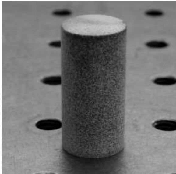
Figura 7.27 - Padrão speckle gerado no provete de resina RenShape® SL 7810.
