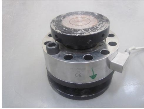
Fig. 32 Célula de carga
