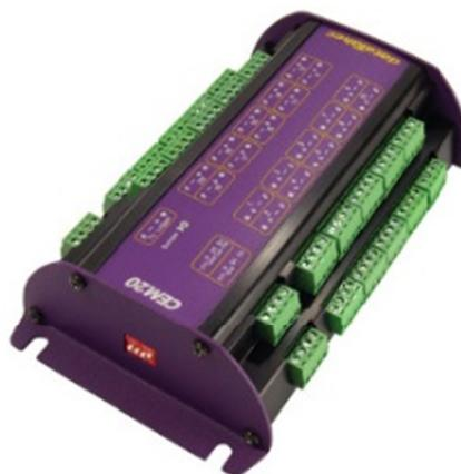
Fig. 9 Multiplexagem para DataTaker™ DT8x
