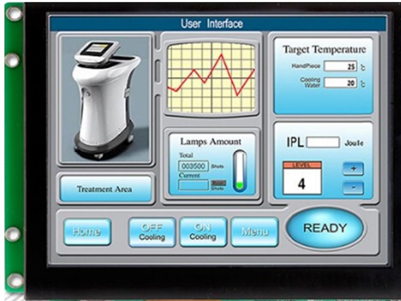
Fig. 19 Painel TFT RS-232 sensível ao toque
