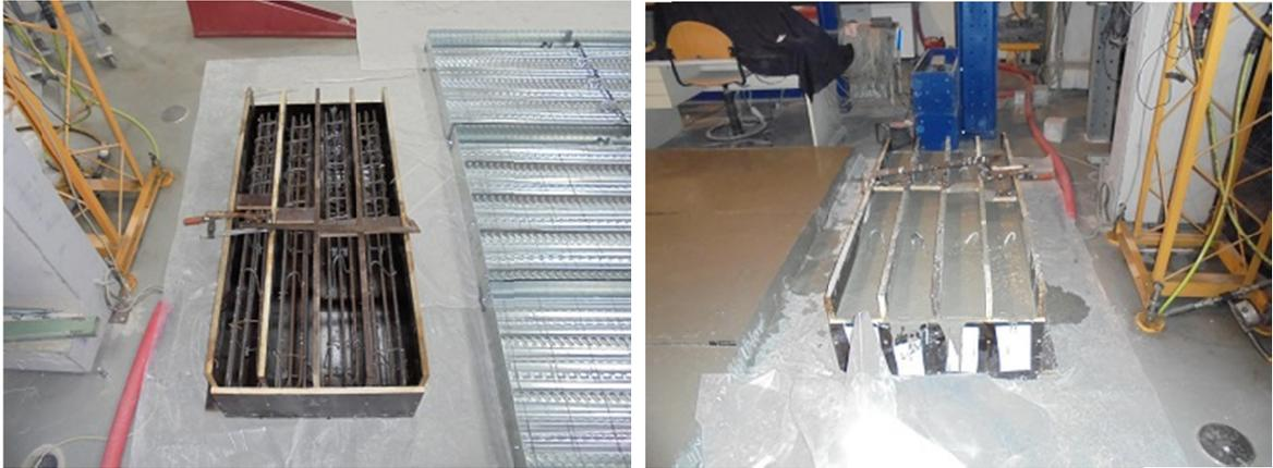
Fig. 55 Montagem e betonagem das vigas VDA1 a VDA4
