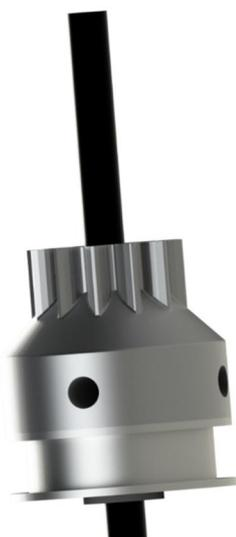
*Figura 4.18 - Representação do guiamento da polia e do pinhão desenvolvido em SolidWorks*
