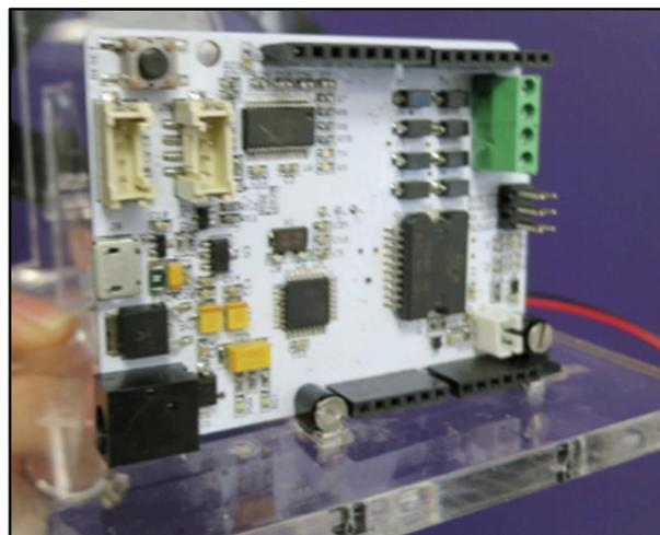
*Figura 2.19 - PCB utilizado no Hapkit [67]*
