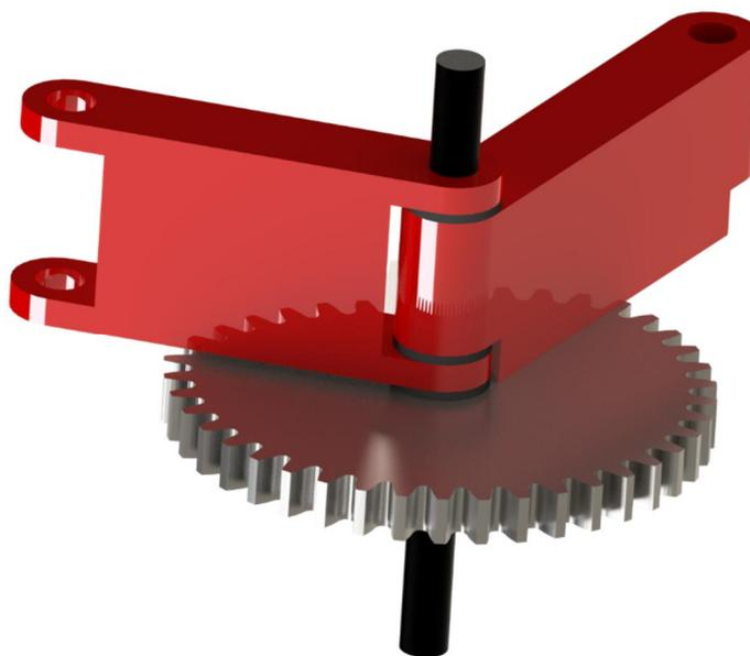
*Figura 4.21 - Representação da barra de acionamento de maior altura rigidamente ligada à roda dentada*
