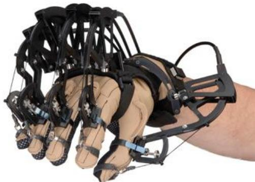
Figura 2.8 – *CyberGrasp*, dispositivo háptico móvel [27]
