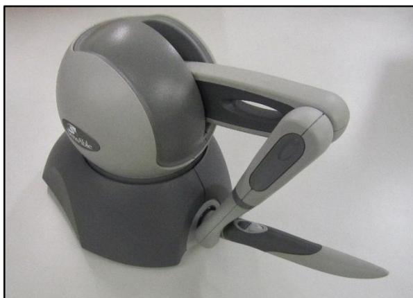
*Figura 2.10 - Geomagic Touch, dispositivo háptico com feedback de força disponível no LIM*
