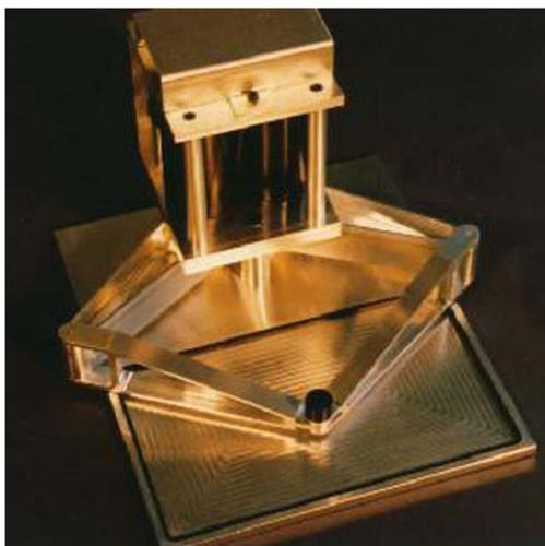
*Figura 2.20 - Primeiro protótipo do Pantógrafo, dispositivo háptico desenvolvido por Vincent Hayward e Christophe Ramstein [71]*
