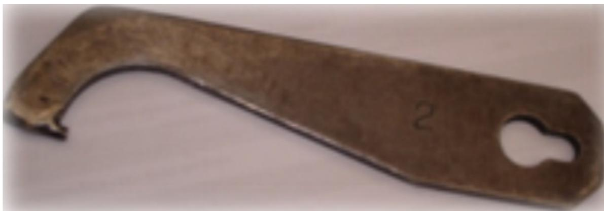
Figura 31- Ferramenta para remoção do tubo extrator
