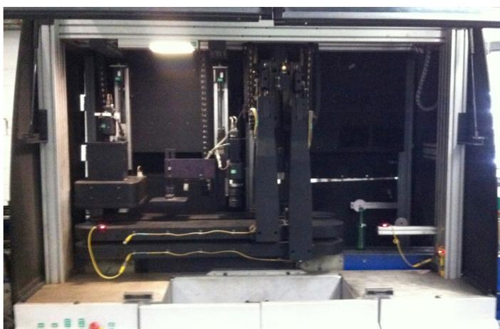
Figura 13- Interior de uma máquina de inspeção visual de topo e fundo
