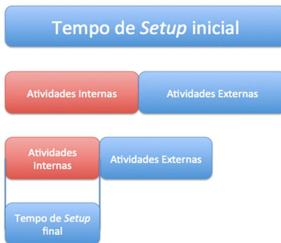
Figura 6- Esquema ilustrativo dos estágios do SMED
