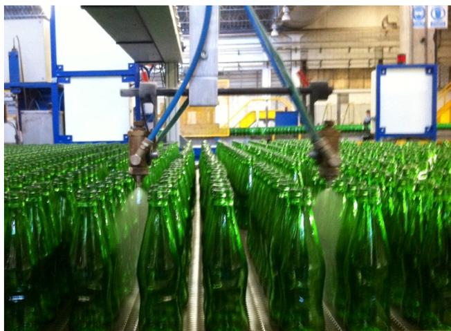
Figura 11- Aplicação do tratamento de superfície a frio
