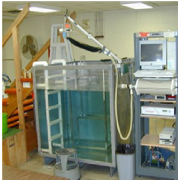
Figura 2.2: Pesagem através de Imersão [2]
