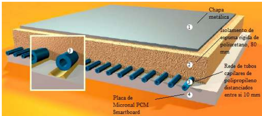
Figura 44: Representação do painel ILKATHERM para arrefecimento de tetos falsos e respetiva legenda (de Aguiar, 2009).
